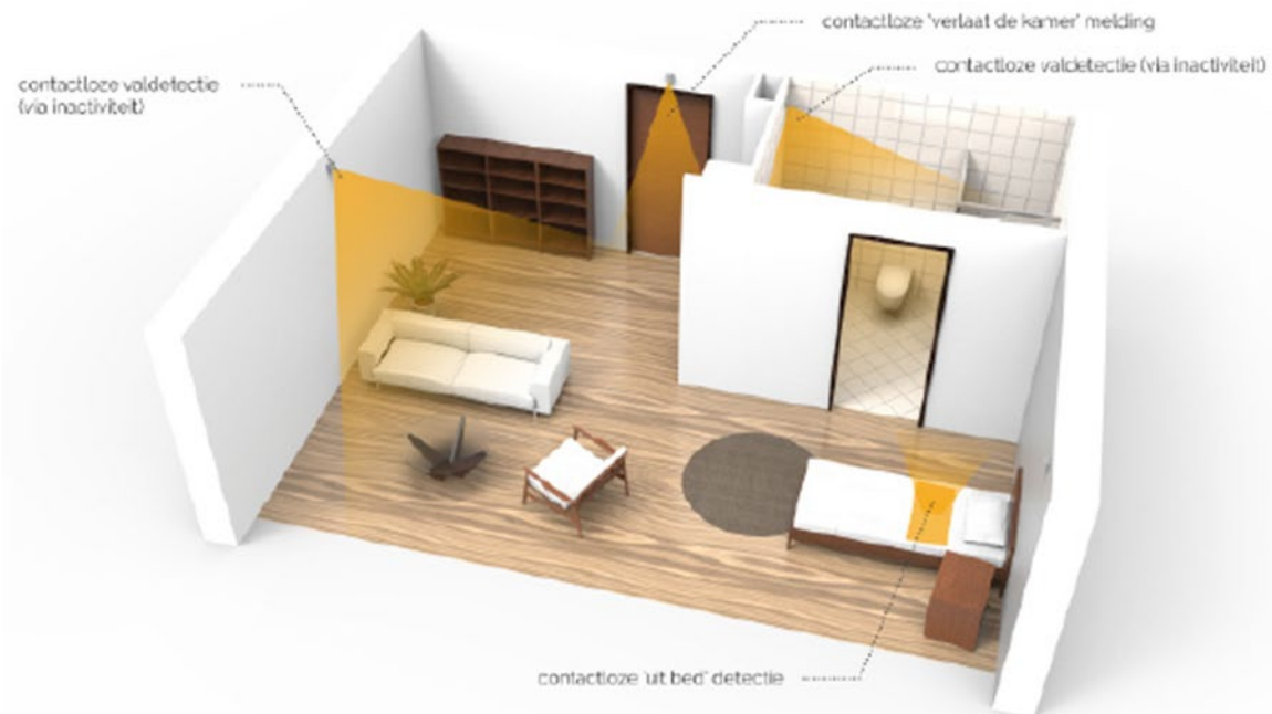
Figuur 2: Voorbeeld van sensorische bewaking derde generatie, het Unattended Autonomous Surveillance (UAS) systeem van Ascom/Dutch Domotics (2015) †
